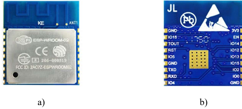
Şekil 4.14: WiFi Alıcı - Verici Modülü ESP-WROOM-02 a) Üstten Görünüm b) Alttan Görünüm
