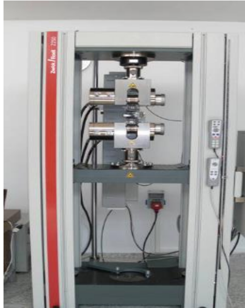
Şekil 4.5: Çekme Testi Cihazı
