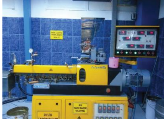
Şekil 4.1: Çift vidalı ekstruder
