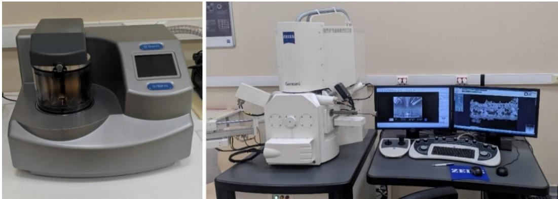
Şekil 4.8: Q150R ES Altın kaplama cihazı ve Zeiss Sigma 300 VP SEM cihazı
