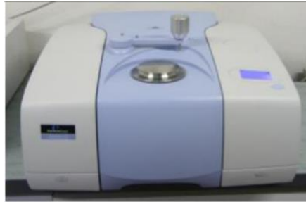
Şekil 4.7: Perkin Elmer Spectrum 100 FTIR cihazı
