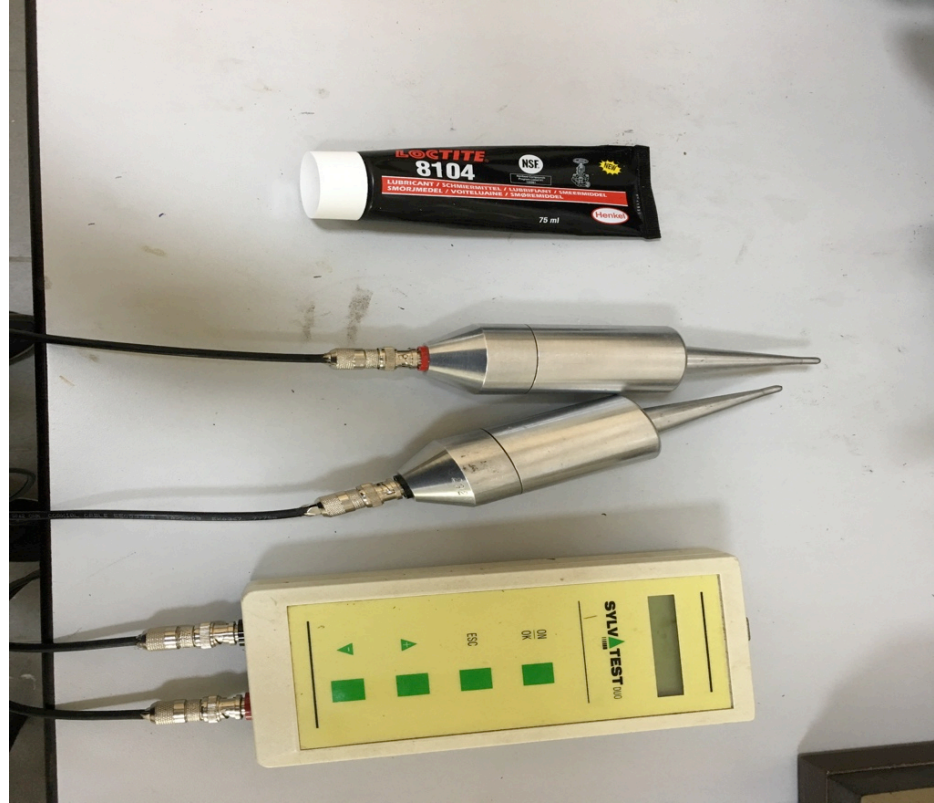
Şekil 3.12 : Ses iletim hızının ölçümünün yapıldığı diğer cihaz
