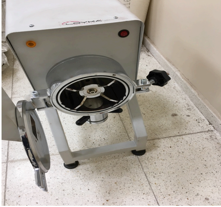
Şekil 3.2 : Odun unu hazırlamasında kullanılan LOYKA marka öğütücü
