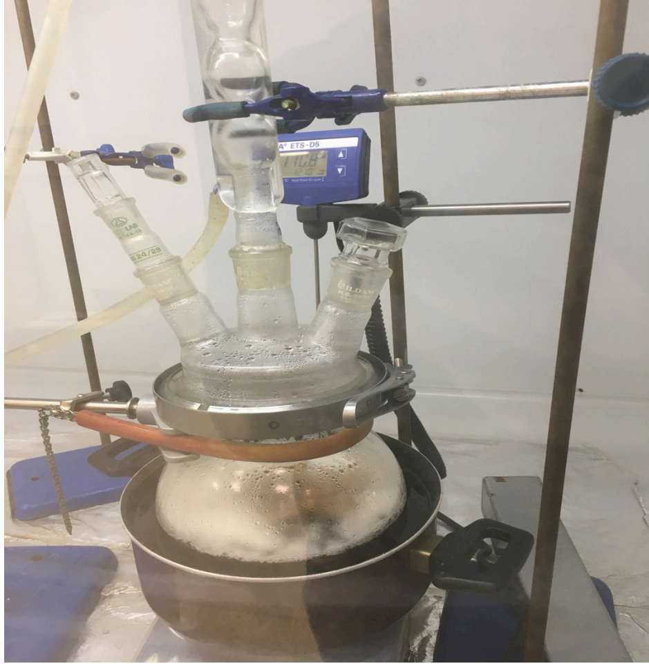
Şekil 3.8 : Küçük boyutlu odun bloklarının kimyasal modifikasyon işleminin gerçekleştirildiği deney düzeneği
