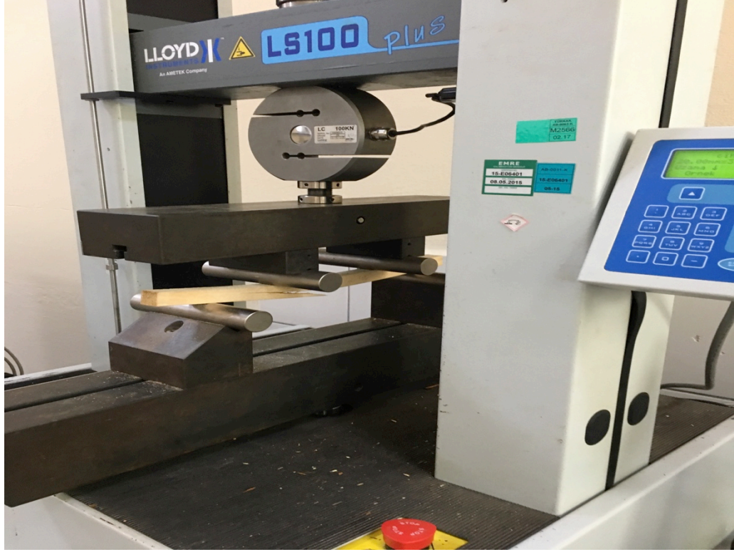
Şekil 3.14 : Eğilme ve elastikiyet modülü deneylerinin yapıldığı universal test cihazı
