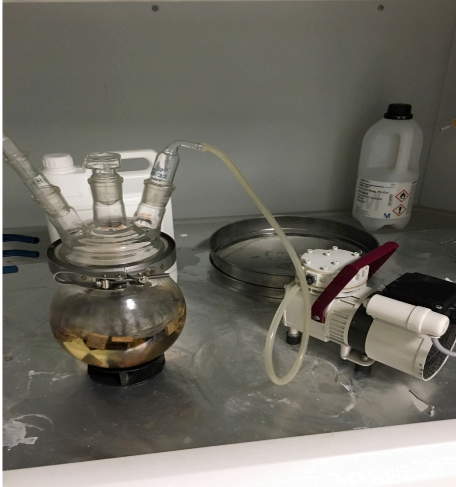
Şekil 3.7 : Boyutsal sabitlik testi yıkama döngüsünün gerçekleştiği düzenek
