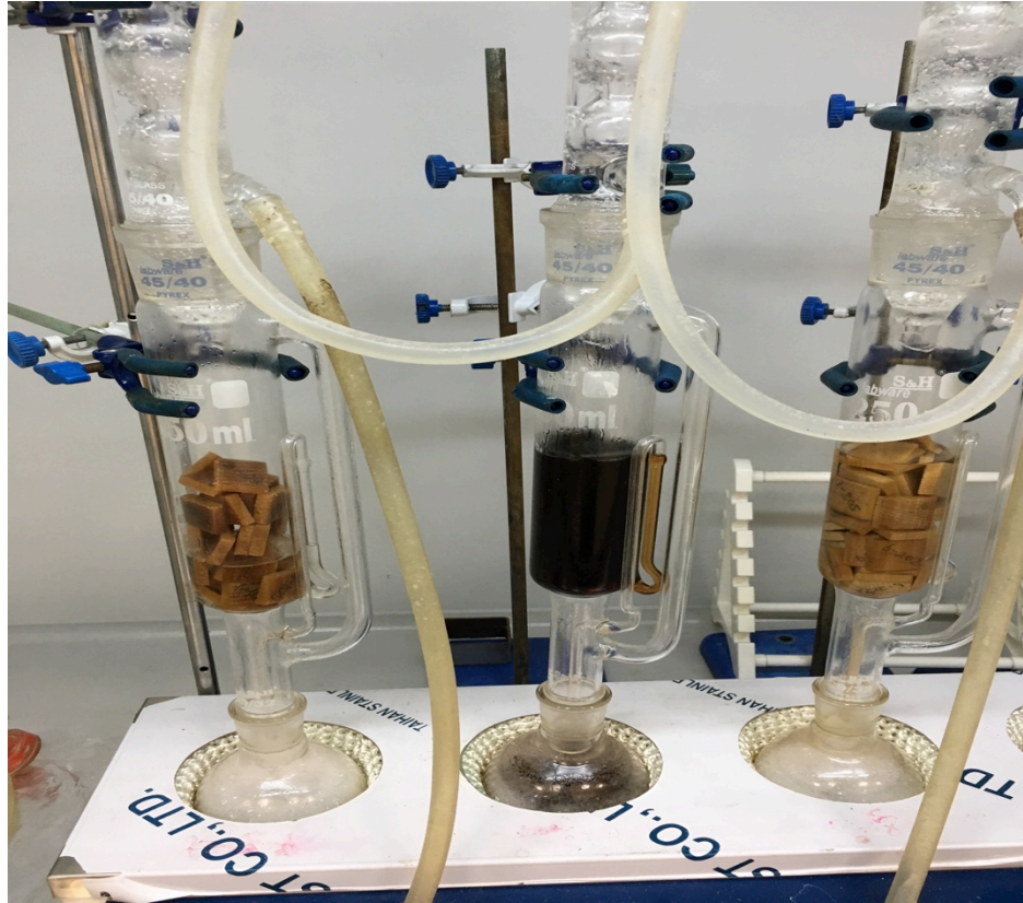
Şekil 3.3 : Ekstraksiyon işleminin yapıldığı sokslet cihazına ait görsel
