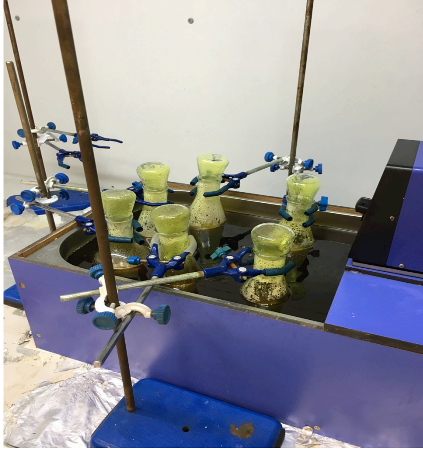
Şekil 3.4 : Delignifikasyon işleminin gerçekleştirildiği deney düzeneği
