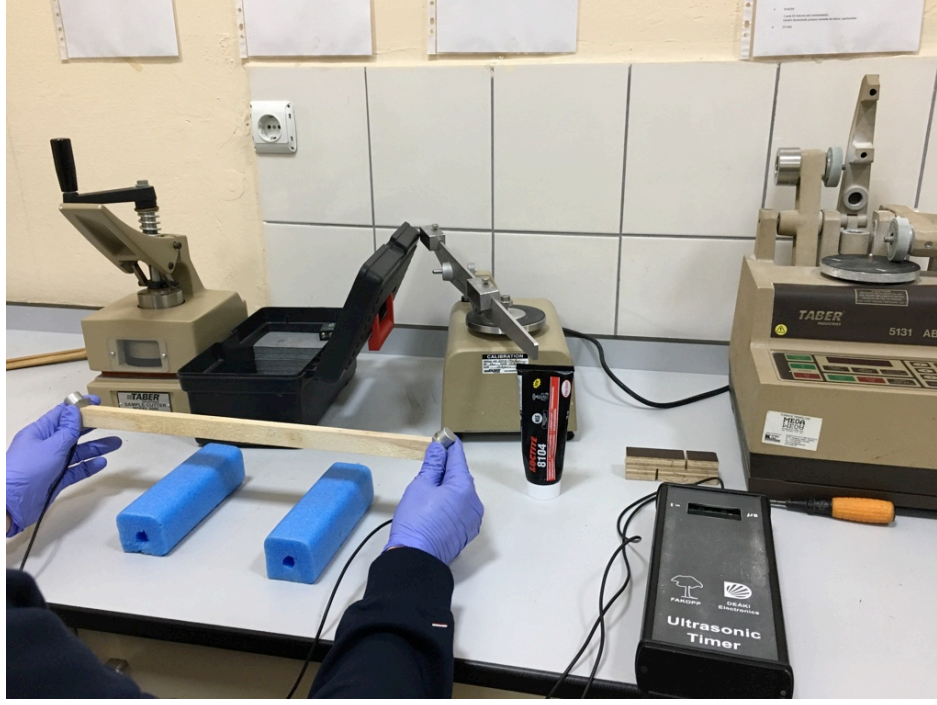
Şekil 3.11 : Ses iletim hızının ölçümünün yapıldığı ultrasonik cihaz
