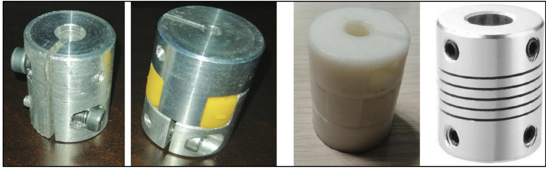
Şekil 5.12: (a) Birinci kaplin modeli (b) İkinci kaplin modeli (c) Üçüncü kaplin modeli (d) Dördüncü kaplin modeli
