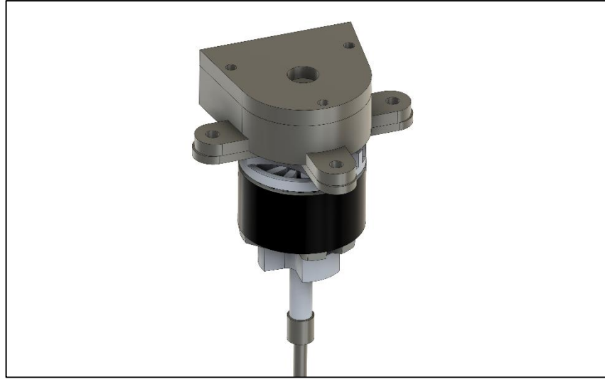
Şekil 5.14: Freze çakısının bağlandığı motorun uç efektöre bağlantı parçası
